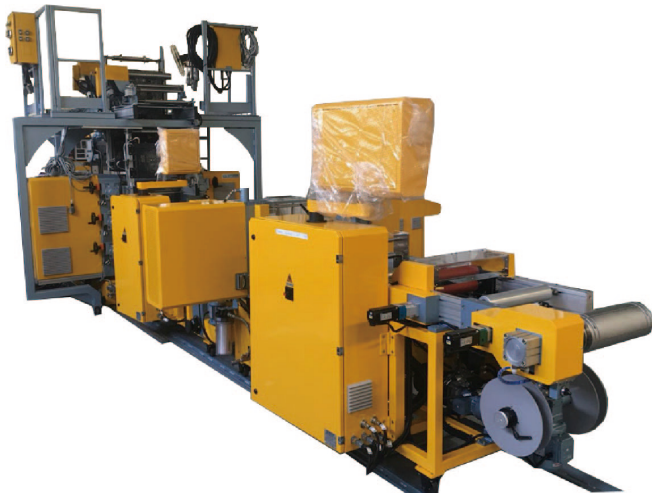
图2 北航团队搭建的热熔法制备热塑性预浸料生产线
